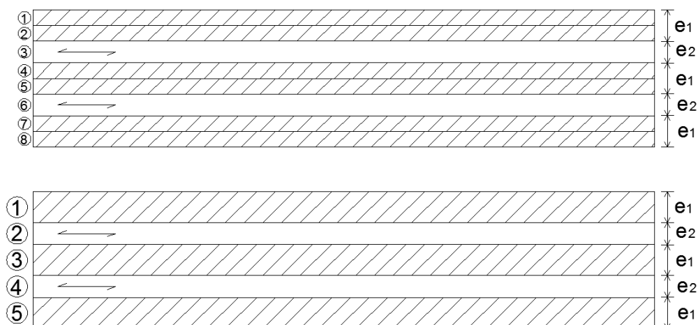
Figura 3.1 – Painel utilizado (em cima) e painel equivalente (em baixo)
