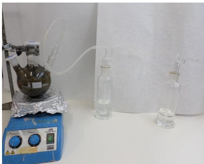
Figura 4.1 - Esquema de montagem para o tratamento de Fenton e quantificação de CO 2 libertado durante a reação.
