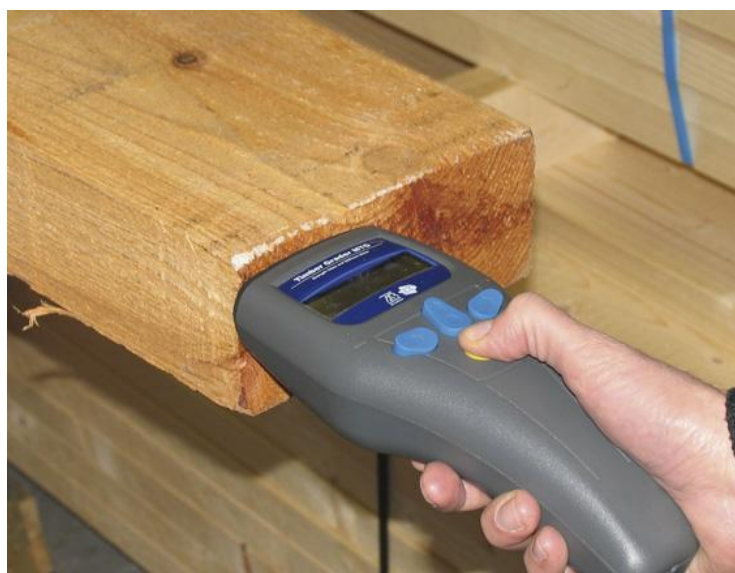
Figura 3.6 – Utilização do equipamento comercial Timber Grader MTG
