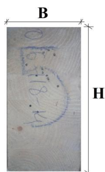
Figura 3.2 – Secção transversal das vigas
