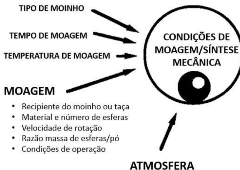
Figura 3.2 - Principais parâmetros a considerar no processo de moagem/síntese mecânica [Adaptado de (Campbell, et al. , 1996 )].
