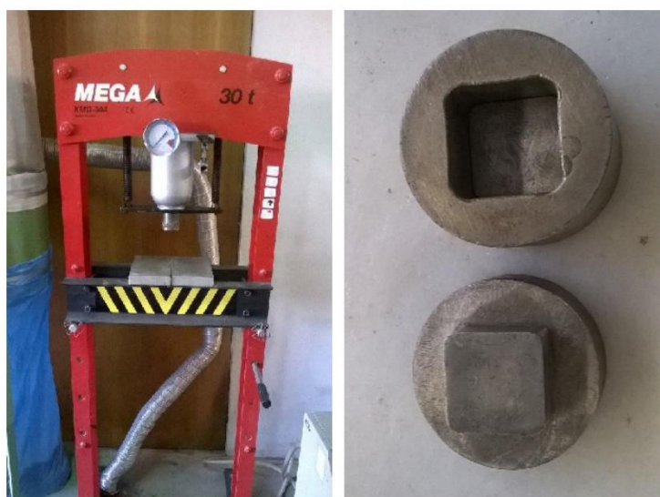
Figura 3.4 - Prensa hidráulica e matriz da prensagem.
