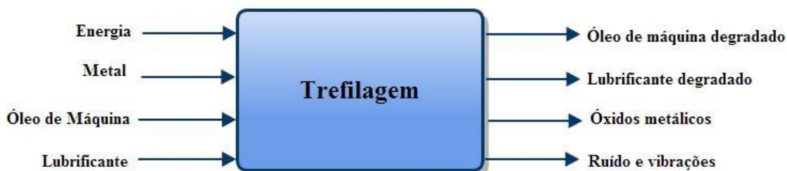
Figura 2.2 - Diagrama de caracterização das entradas e saídas (resíduos) do processo de trefilagem (Almeida P., et al. , 2011).
