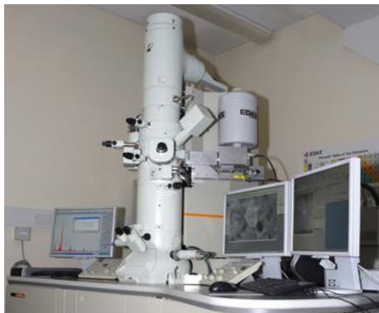
Figura 3.7 – Equipamento de TEM. Adaptado de (Andreas, 2011).
