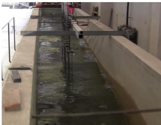
Figura 4.12 - Zona de instabilidade na localização das 8 sondas com uma onda de geração T7H1.5.
