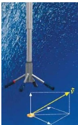
Figura 3.9 – ADV e as três componentes ortogonais.
