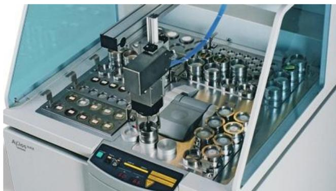
Figura 2.7 - Espectrofotômetro de Raios X
