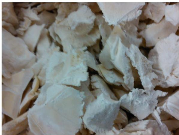
**Figura B.0.3 – Aspeto do PVC aditivado com pó de casca de ovo após granulação**
