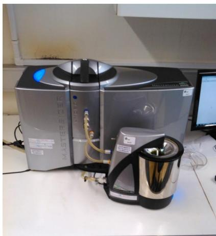
**Figura 2.6 - Difração de partículas por laser (Mastersizer 2000, da marca Malvern).**
