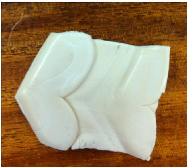
Figura B.1 – Aspeto do PVC aditivado com BSH após mistura na Plastograph
