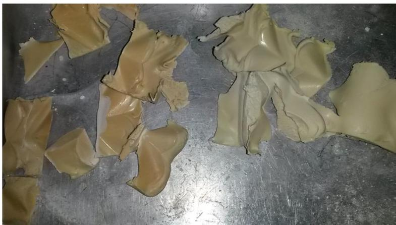
**Figura 4.2 – Variação da cor da mistura em função do tempo de ensaio (esq. 10 min; dir. 7 min).**
