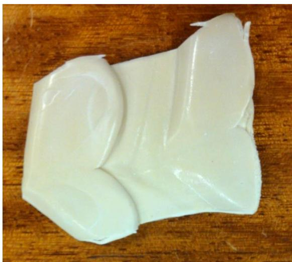
Figura B.0.1 – Aspeto do PVC aditivado com pó de casca de ovo após mistura na Plastograph
