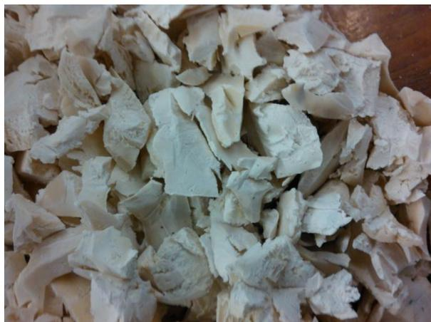
**Figura B.0.2 – Aspeto do PVC aditivado com BSH após granulação**
