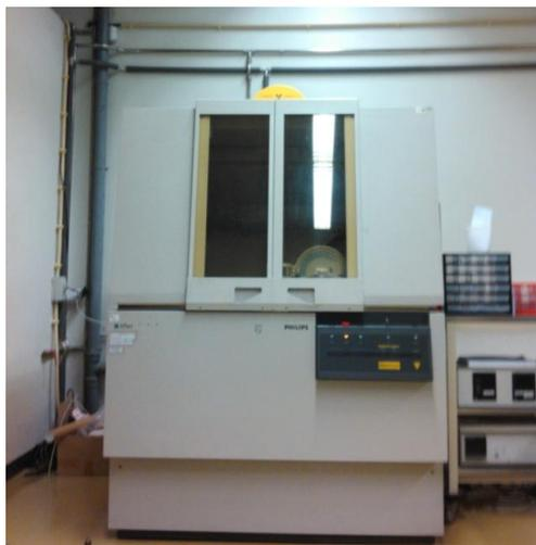
Figura 2.8 - Difratómetro de Raios X, modelo PW 1710, da marca Phillips
