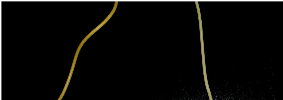
**Figura 4.5 – Coloração do fio extrudido (esq. carga: pó de casca de ovo; dir. carga:BSH)**
