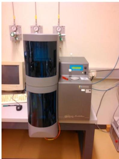
**Figura 2.10 - Equipamento de termogravimetria, modelo Evolution, da marca SETSYS**
