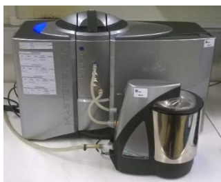
Figura 11 – Equipamento de análise granulométrica
