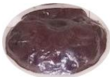
Figura 33 – Aspeto visual do provete QB_3 com 10% casca de ovo pós sinterização
