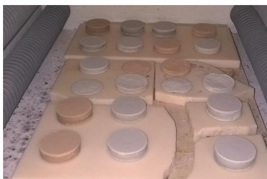
Figura 26 – Aspeto dos “verdes” antes da sinterização
