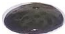
Figura 32 - Provete QB_2 com 20% Pó de Mármore sinterizado a 1150°C
