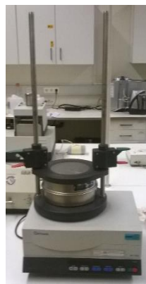
Figura 10 – Equipamento de crivagem
