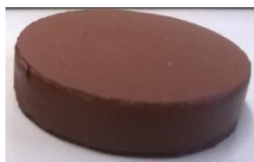
Figura 29 - Provette QB_2 com 20% Perlite sinterizado a 1200°C
