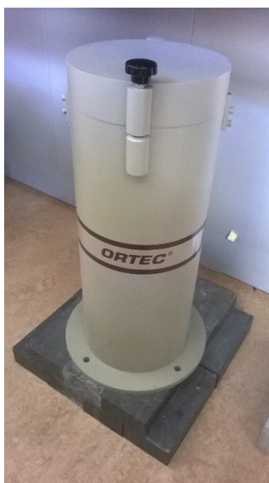
Figura 6 - Espectrómetro para medir elementos radioativos
