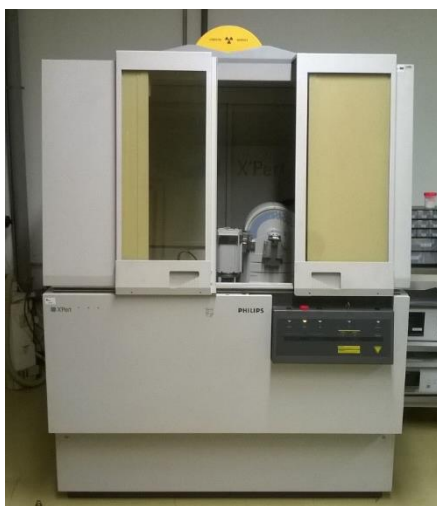
Figura 5 - Difratómetro de raios X
