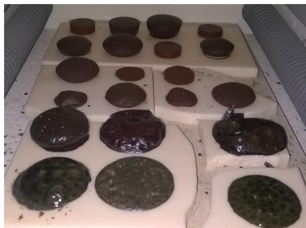
Figura 27 – Aspetto dos provetes após sinterização ( T_{max}=1200^{\circ}C )
