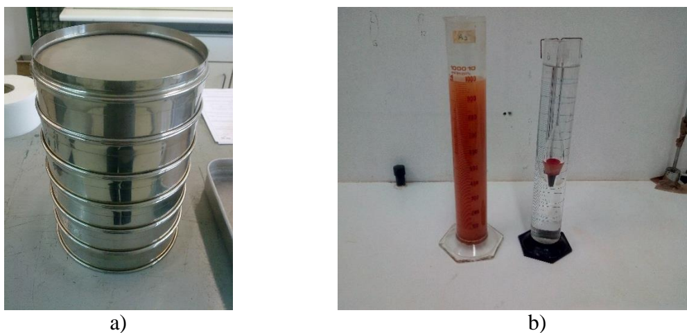
Figura 5.3 – a) Conjunto de peneiros para a realização da peneiração; b) proveta com o solo em suspensão e outra com água destilada que contém no interior o densímetro e o termómetro.
