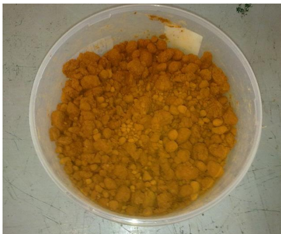
Figura 5.8 – Preparação das amostras com o teor em água próximo do limite de plasticidade.
