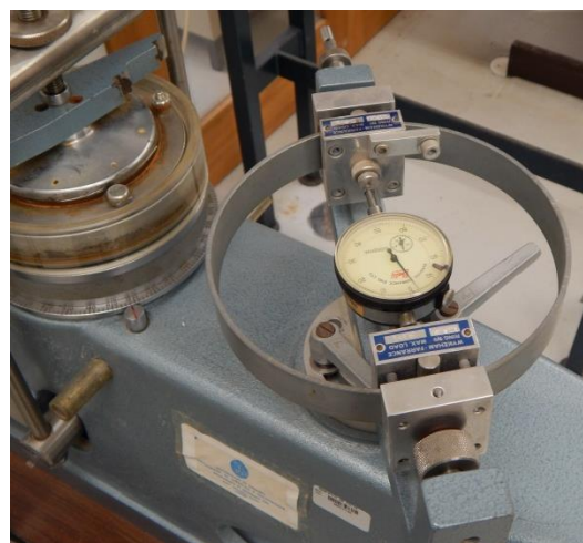
Figura 3.2 – Caixa de corte anelar rotativa: dispositivos que registam a deformação vertical e a força resistente ao corte.
