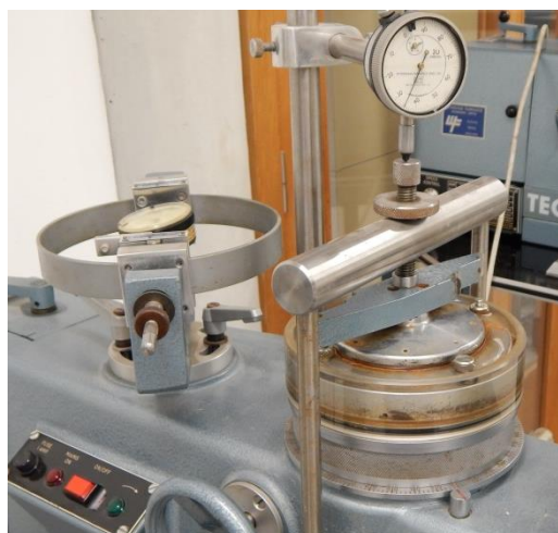
Figura 3.2 – Caixa de corte anelar rotativa: dispositivos que registam a deformação vertical e a força resistente ao corte.
