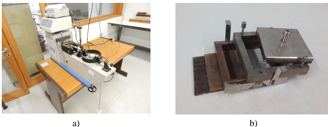
Figura 3.4 - Equipamento de corte direto: a) aspeto geral, b) caixa de corte.
