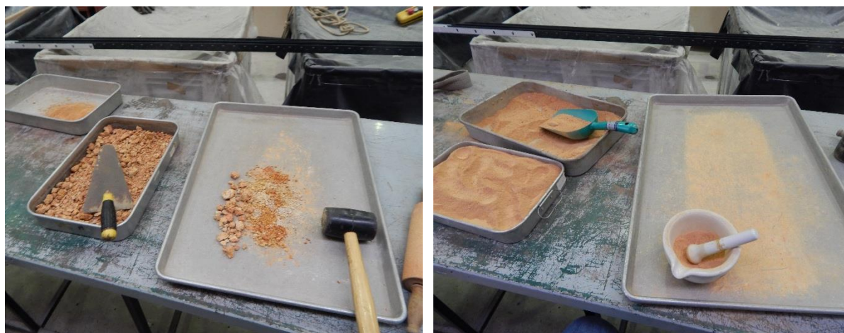
Figura 5.1 – Desagregação do solo para os ensaios.
