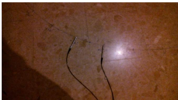
Figura 4.3 – Introdução do microfone ao longo do ensaio (Microfone 1: 50° ; Microfone 2: 60°)
