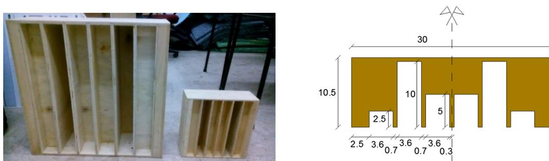
Figura 4.5– Painel QRD\_60 (Esq.) e QRD\_30 (Dir.) (imagem à esquerda). Representação das medições em centímetros dos poços QRD\_30 (dir.).
