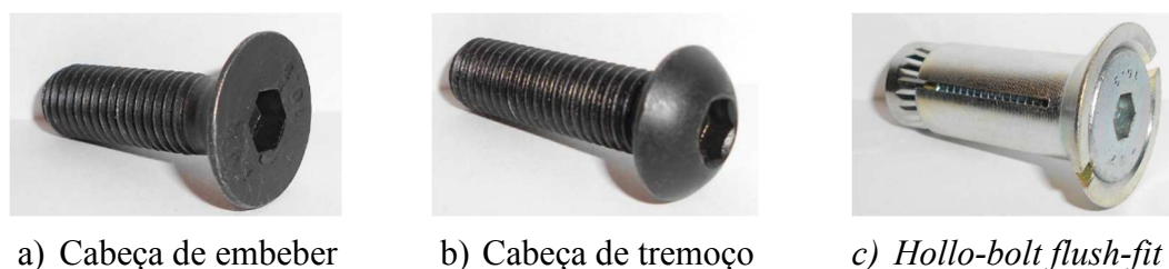
Figura 2.16 - Tipologia dos parafusos utilizados nos ensaios (Carvalho, 2012)
