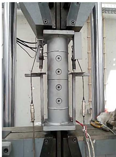
Figura 3.2 – Configuração de uma ligação ensaiada por Vasconcelos (2015)
