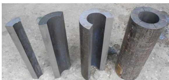
a) Seccionamento do tubo interior
