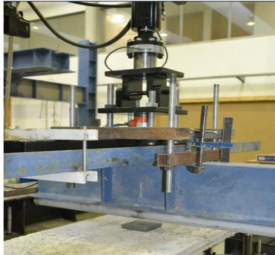
Figura 4.6 - Aplicação da carga no ensaio de rigidez
