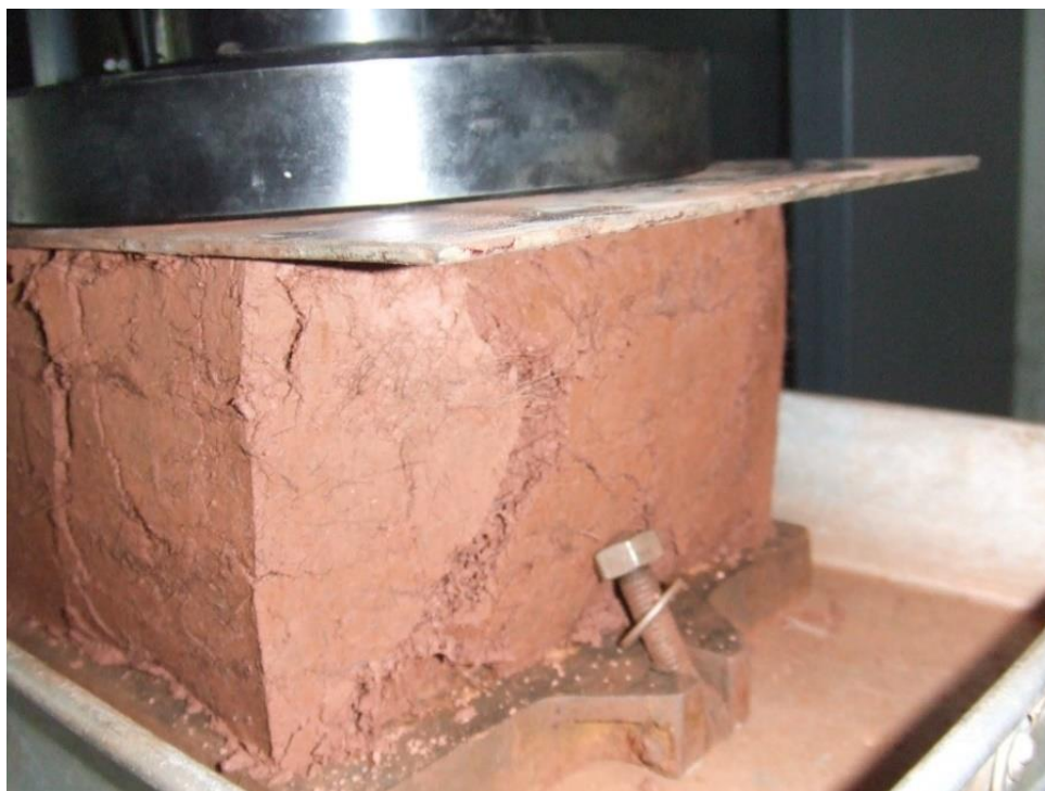
Figura 5. 6 - Rotura de um bloco com reforço durante o ensaio.
