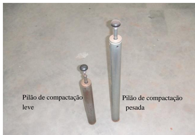
Figura 4. 5 - Equipamento de compactação.
