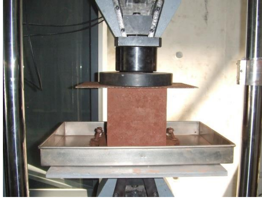
Figura 4. 14 - Bloco de solo a ser ensaiado na prensa hidráulica.
