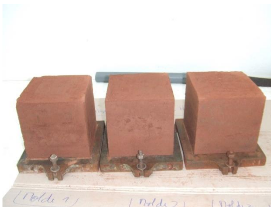
Figura 4. 11 - Blocos submetidos a secagem, em ambiente controlado.
