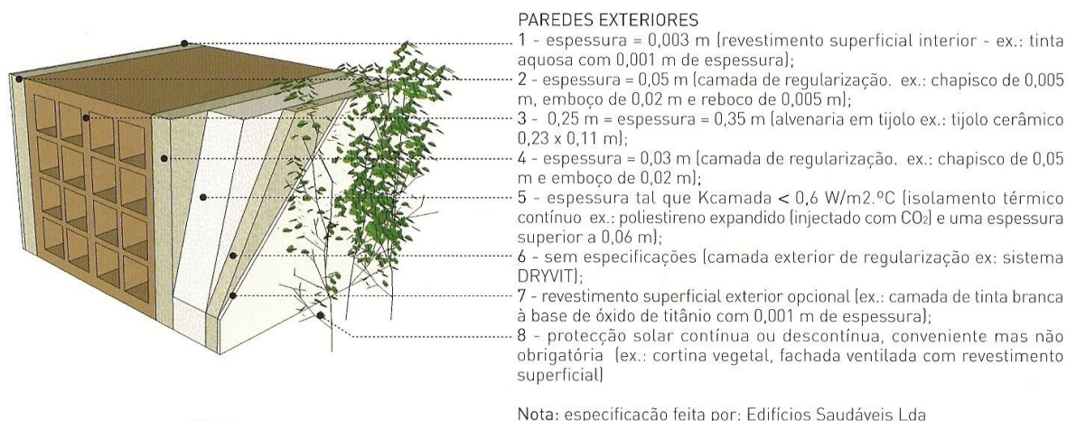
Figura 5.23 – Exemplo de paredes exteriores com isolamento térmico pelo exterior (adaptado de Tirone e Nunes., 2008)
