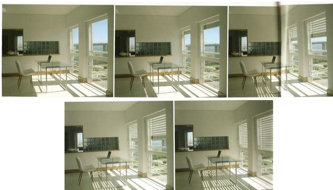
Figura 5.19 – Controlo da luminosidade natural através de sombreamento exterior (adaptado de Tirone e Nunes, 2008)
