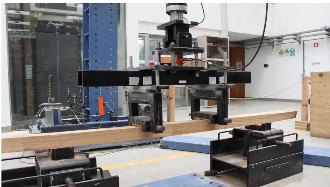
Figura 4.10 – Ensaio para determinação da resistência à flexão,  $f_m$
