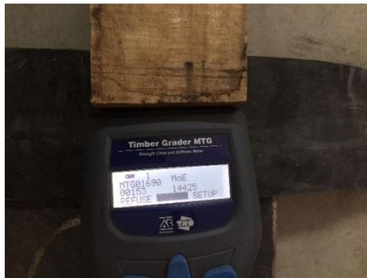
Figura 4.1- Equipamento *Timber Grader MTG*
