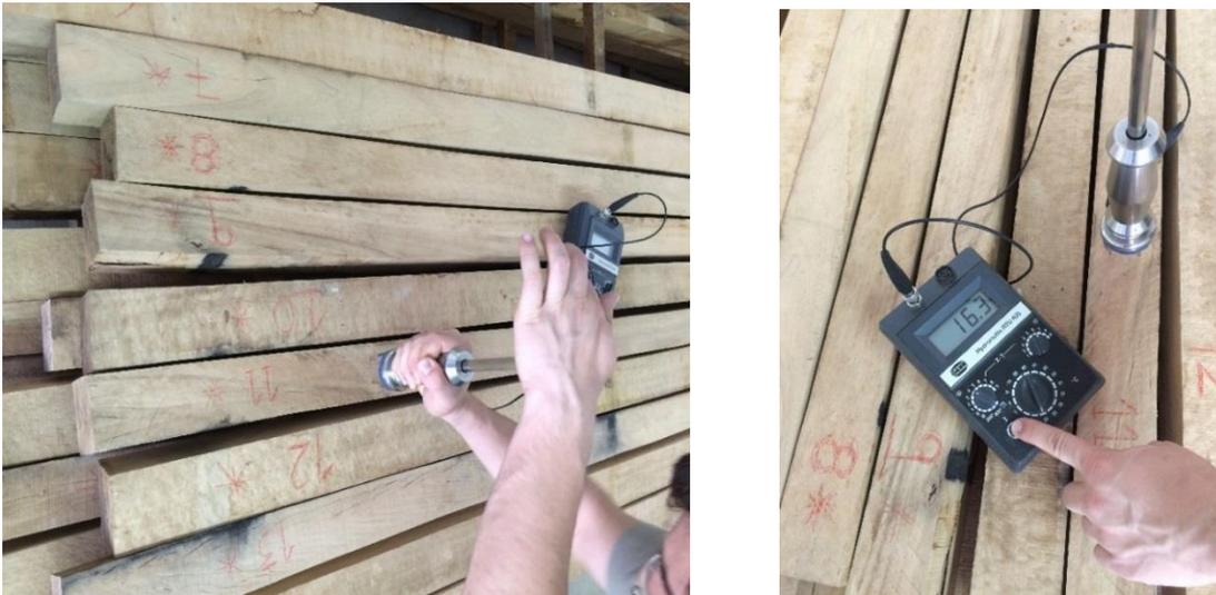
Figura 4.2- Equipamento para medição do teor de água
