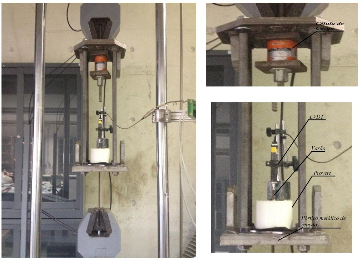
Figura 3.32 – Setup de ensaio.
