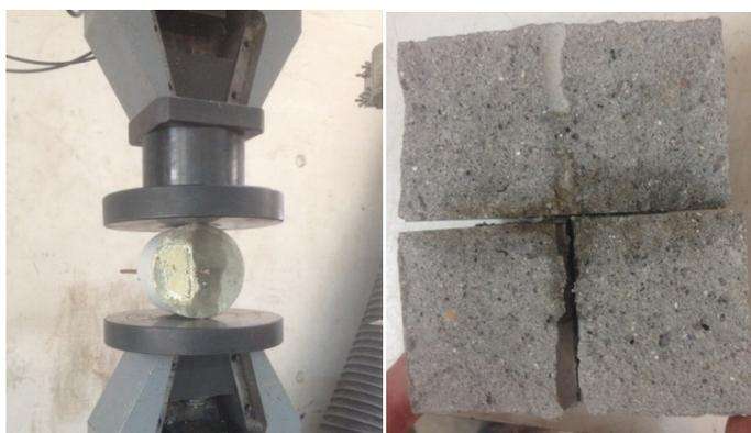
Figura 3.4 – Imperfeições num provete cilíndrico de argamassa.
