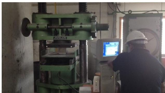
Figura 3.8 – Prensa de ensaio de provetes Cúbicos de betão.
