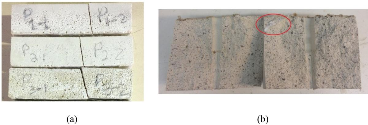
Figura 3.5 – (a) Imperfeições nos prismas retangulares geopoliméricos, (b) Fita adesiva branca no interior da mistura.
