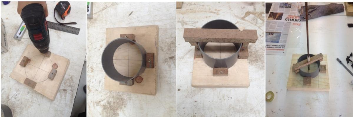
Figura 3.29 – Construção dos moldes dos provetes cilíndricos.
