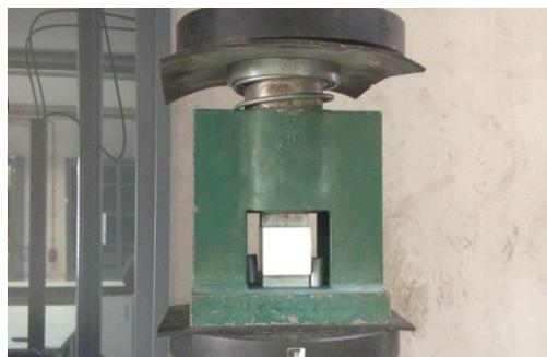
Figura 3.7 – Esquema do ensaio de rotura à compressão.
