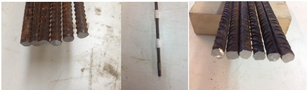
Figura 3.28 – Corte, polimento e isolamento dos varões.
