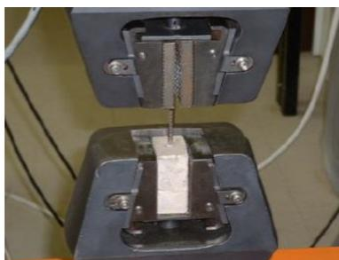
Figura 2.10 – Ensaio de arrancamento por tração Pinto (2002).
