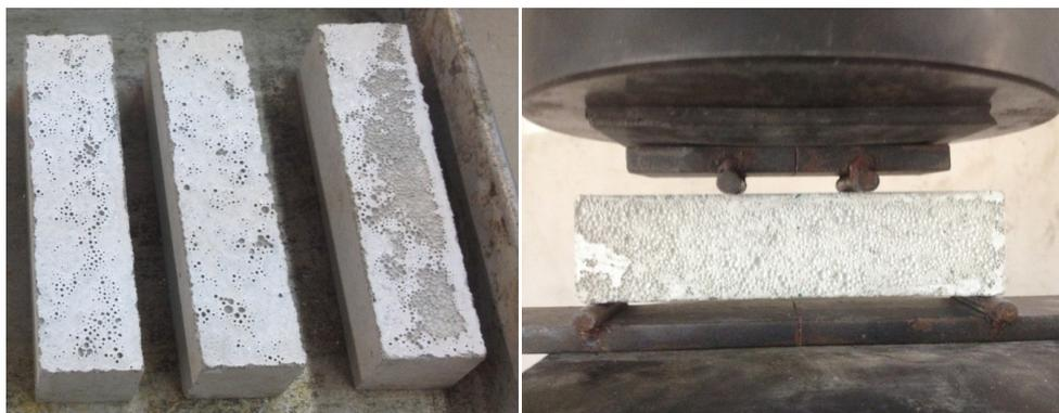
Figura 3.3 – Imperfeições nos provetes de argamassa.
