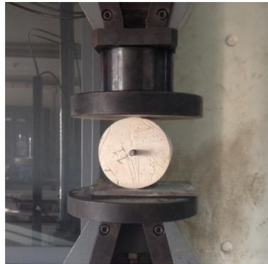
Figura 3.9 – Esquema do ensaio de resistência à tração por compressão diametral.
