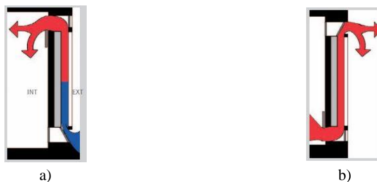
Figura 3.5 – Funcionamento do coletor de ar: a) No inverno; b) No verão (Gonçalves e Graça, 2004).
