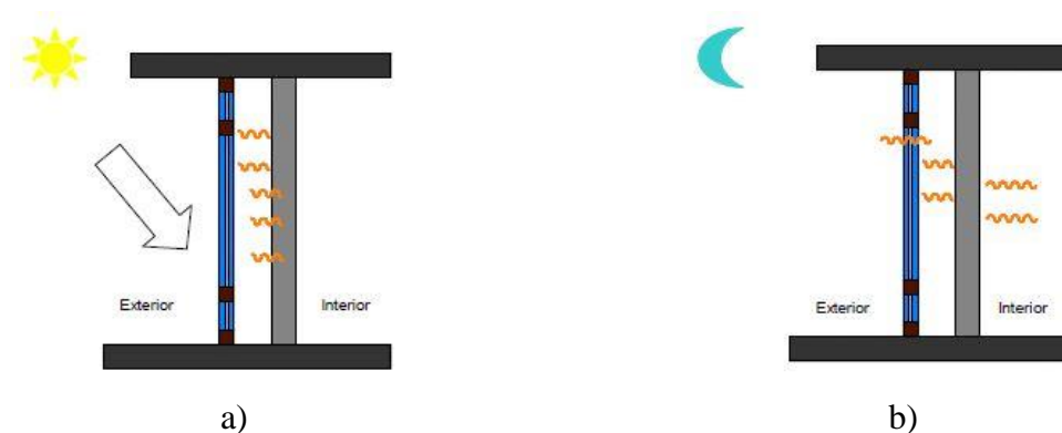
Figura 4.9 – Esquema de funcionamento da parede de Trombe não ventilada: a) Durante o dia; b) Durante a noite (Martins, 2010).
