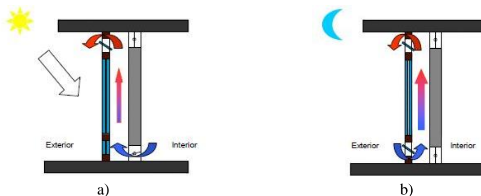
Figura 4.12 – Esquema de funcionamento da parede de Trombe ventilada no verão: a) Durante o dia; b) Durante a noite (Martins, 2010).
