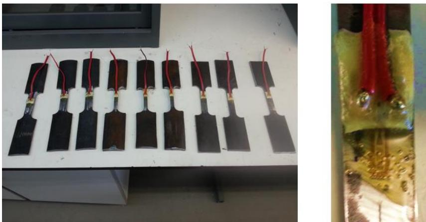
Figura 4.8 - Provetes instrumentados (esquerda) e Pormenor Instrumentação (direita)
