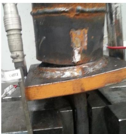
Figura 4.60 - Deformação final zona de rotura
