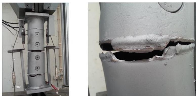
Figura 4.63 - Deformação Final (esquerda) e Rotura Local (direita) - Ligação CE-1
