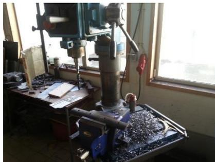
Figura 4.39 - Processo de Furação das Chapas Interiores
