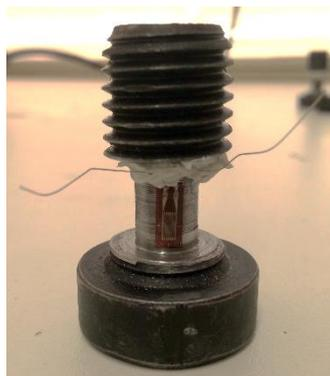
Figura 4.29 - Exemplo de Parafuso Instrumentado
