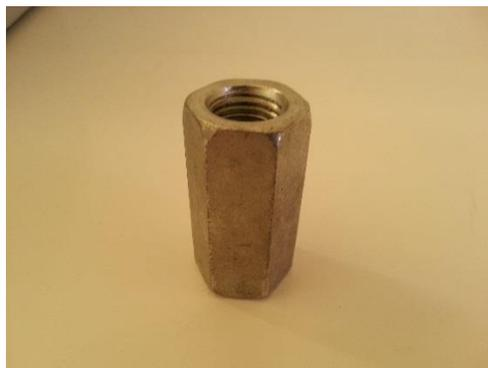
Figura 4.24 - Peça Auxiliar de Agarre Zona Roscada
