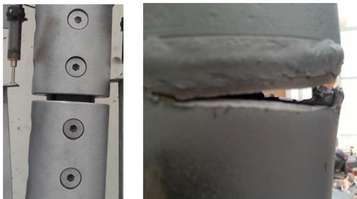
Figura 4.64 - Deformação Final (esquerda) e Rotura Local (direita) - Ligação CE-2
