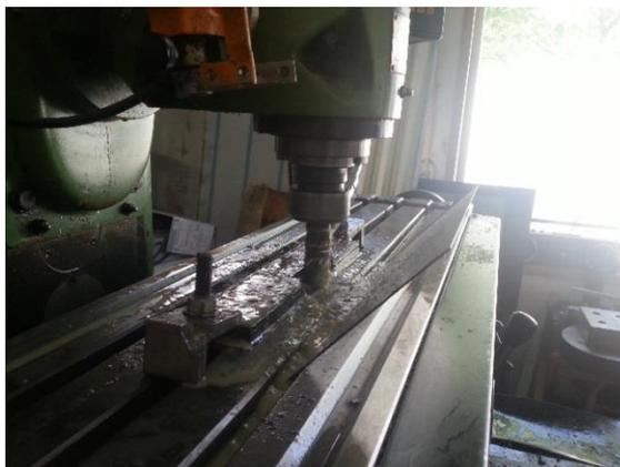
Figura 4.3 – Execução dos Provetes de Aço
