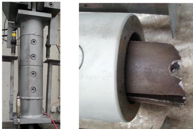
Figura 4.62 – Proverte Inicial (esquerda) e Rotura Local (direita) - Ligação SH-2
