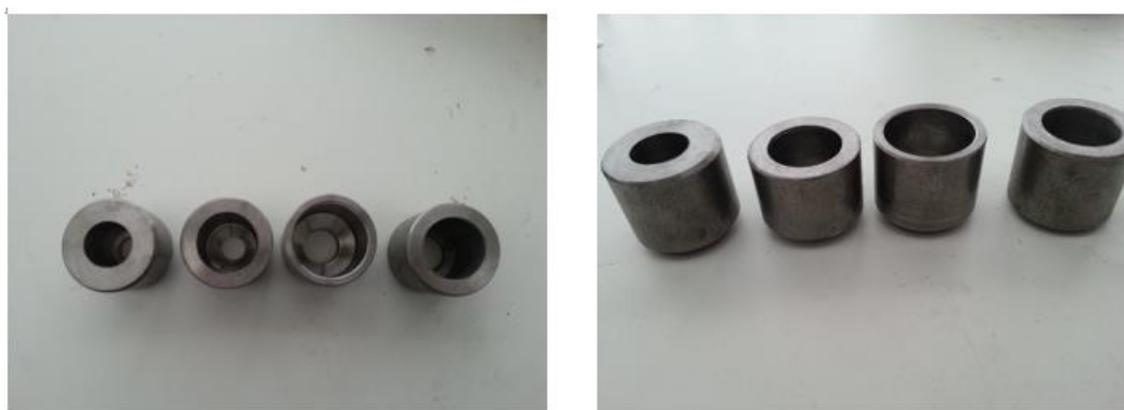
Figura 4.25 - Peças Auxiliares de Agarre Zona da Cabeça do Parafuso
