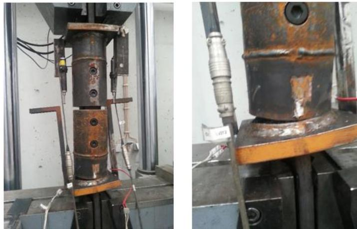
Figura 4.61 - Deformação Final (esquerda) e Rotura Local (direita) - Ligação SH-1
