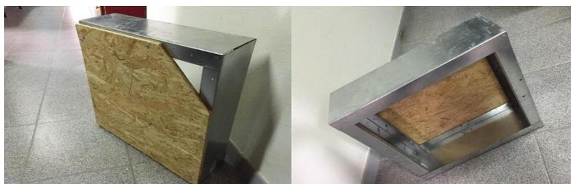
Figura 2.13 – Perfil horizontal com secção em U, perfil vertical com secção em C e Painel de OSB.
