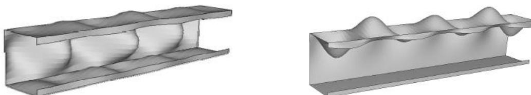
**Figura 2.17 – Modo local de placa (a) em pilares e (b) em vigas (Adaptado de [20]).**
