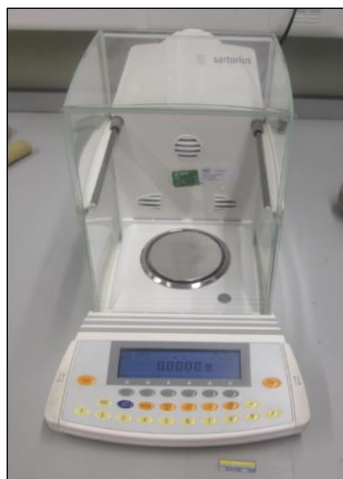
Figura 3.2- Balança utilizada na análise granulométrica dos materiais.
