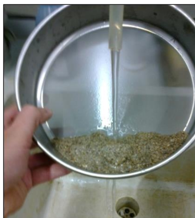
Figura 3.5- Lavagem dos agregados sobre o peneiro 0,063mm.
