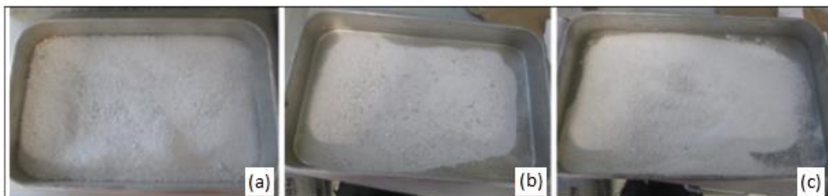
Figura 3.1- Resíduos aplicados no estudo: (a) porcelana vidrada; (b) faiança vidrada; (c) faiança não vidrada.
