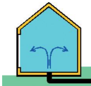
Figura 3.8 – Esquema representativo de arrefecimento indireto pelo solo (Gonçalves e Graça, 2004).
