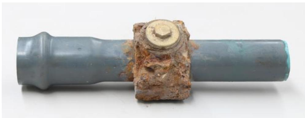
Figura 3.3 – Exemplo de uma conduta onde ocorria uma fuga.
