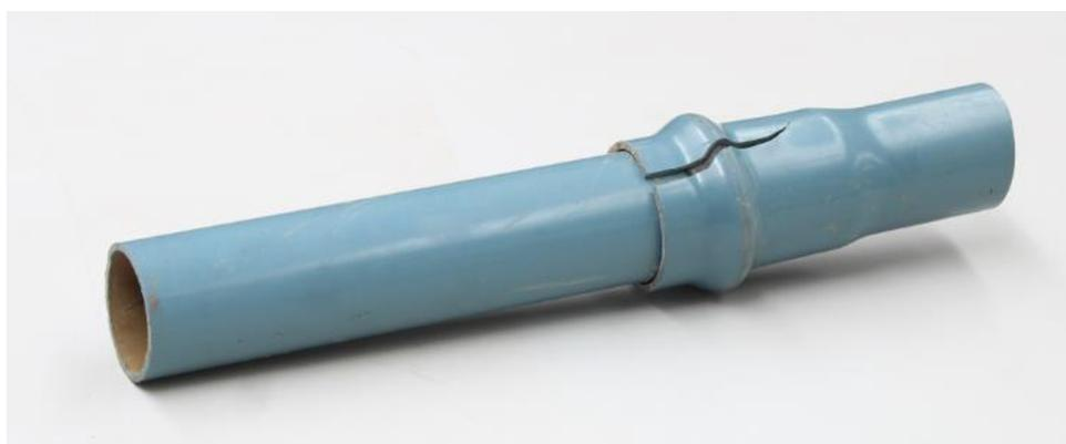
Figura 3.6 – Troço de conduta com uma fenda de 8.5 cm na junção de duas partes.
