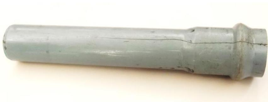
Figura 3.4 – Troço de conduta com uma fenda de 24 cm.
