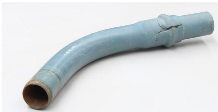
Figura 3.7 – Troço de uma conduta com uma fenda de 8 cm.
