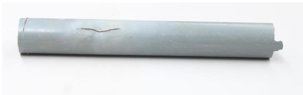
Figura 3.5 – Troço de conduta com uma fenda de 8.3 cm.
