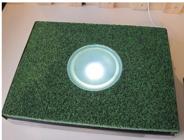
Figura 2.17 – Módulo piezoelétrico da PAVEGEN Systems
