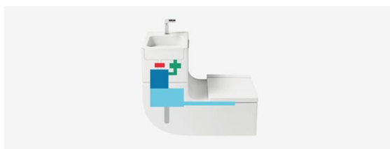
Figura 2.4 – Sistema integrado lavatório – sanita (Roca@, 2015)
