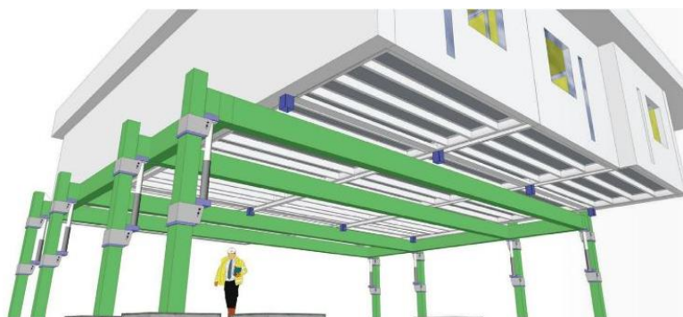
Figura 1.3 – Edifício FRAMEUP, elevação e integração de módulos 3D (FRAMEUP, 2013)
