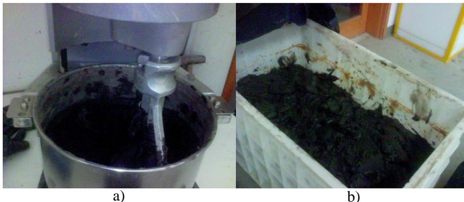
Figura 4.1 – Homogeneização e armazenamento de solo: a) Mistura mecânica do solo na misturadora Sammic *BM11*; b) Solo após duas misturas e pronto a ser armazenado.
