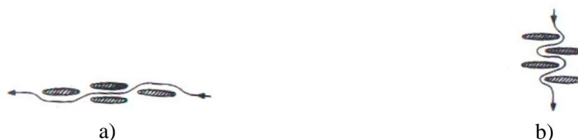
Figura 2.5 – Sinuosidade dos caminhos a percorrer pela água: a) Direção horizontal; b) direção vertical (Serra, 2009).
