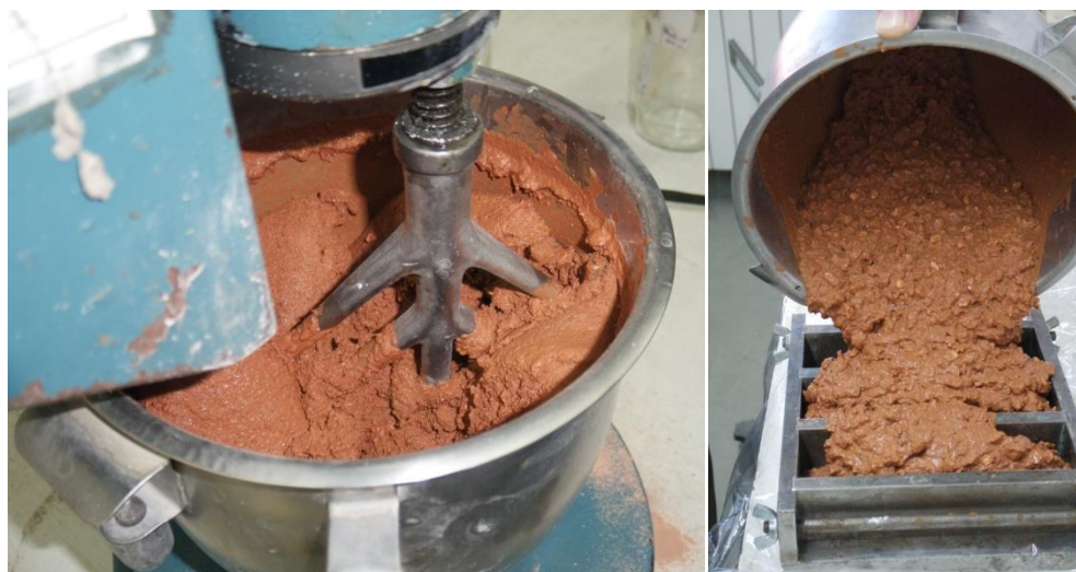
Figura 3-12 – Consistência da mistura com alteração das quantidades de ligante (esquerda) e de agregados (direita).
