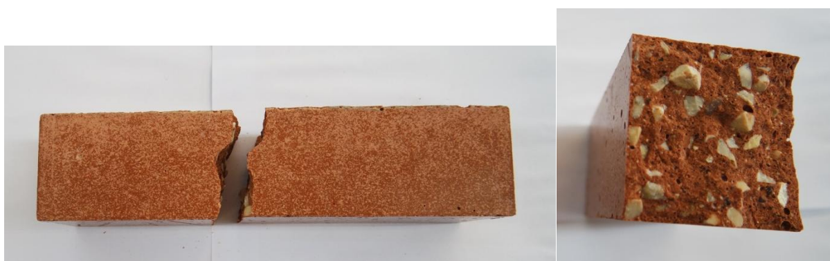
Figura 3-17 – Superfície de rotura do ensaio à tração por flexão numa mistura com britas.
