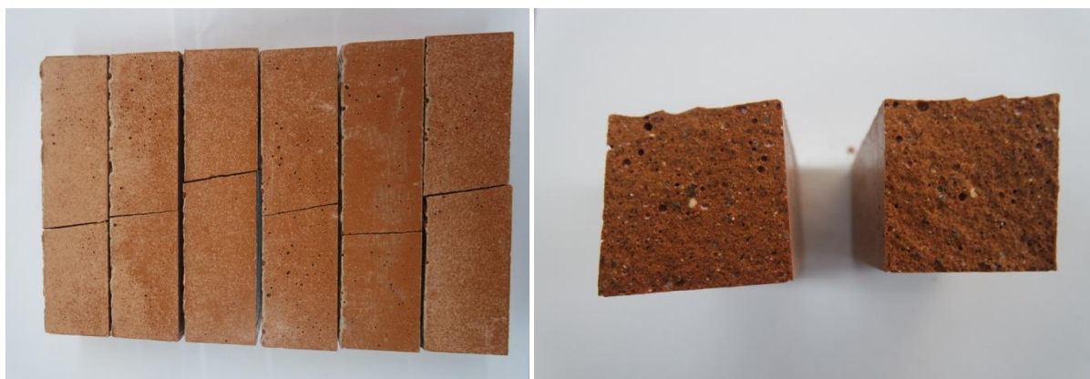
Figura 3-16 – Provetes após rotura à tração por flexão (esquerda). Pormenor da superfície de rotura (direita).
