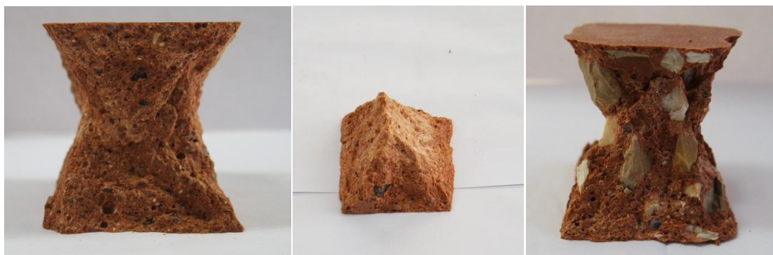
Figura 3-20 – Roturas obtidas. Ensaio de compressão.
