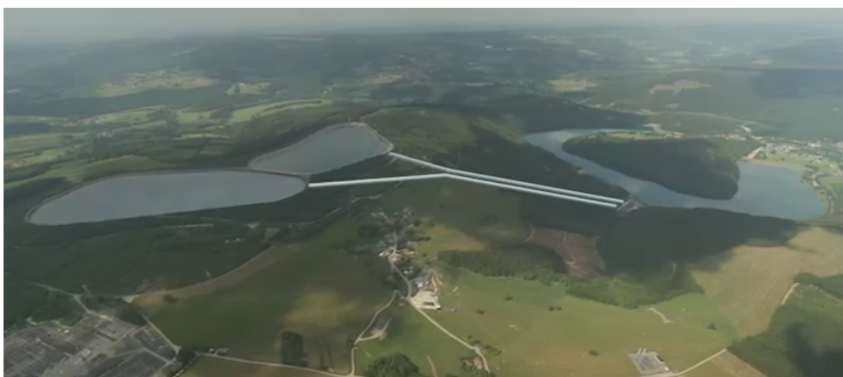
Figura 2.10 – Circuito hidráulico da central de Coo-Trois-Ponts
