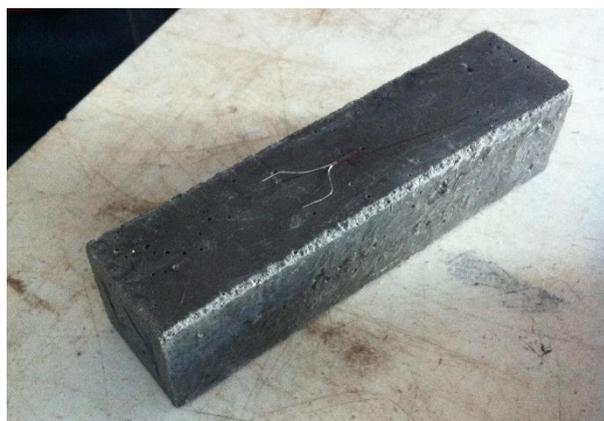
Figura 3.6 – Provete de cinzas com extensómetro.
