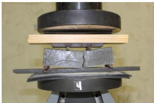
Figura 3.7 – Ensaio de tração por flexão.
