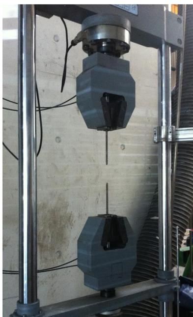
Figura 3.3 – Ensaio à tração do aço.
