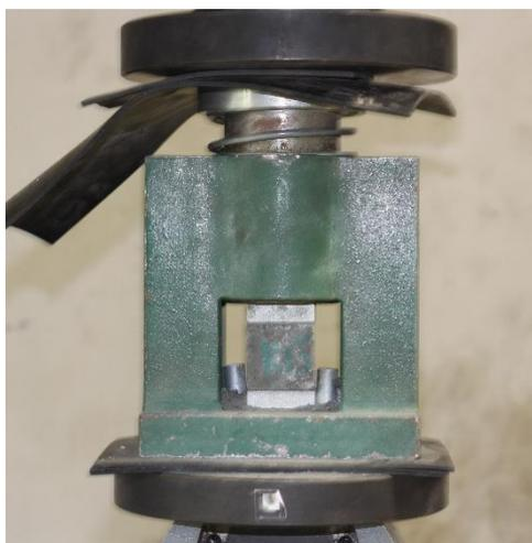
Figura 3.8 – Ensaio de compressão.
