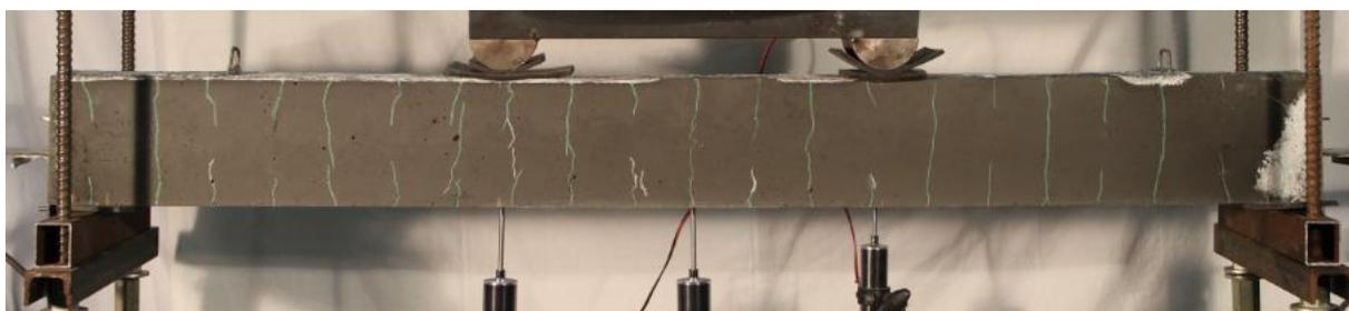
Figura 4.11 – Fissuração existente antes de se iniciar o ensaio na Viga *CIN2*.
