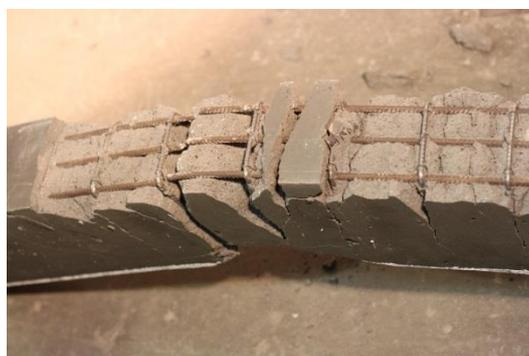
Figura 4.9 – Pormenor do colapso da Viga CIN2.
