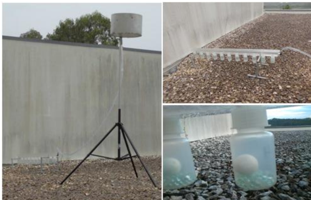
Fig. 3.6. (a) Amostrador sequencial da água da chuva; (b) Pormenor da caleira com os frascos de amostragem; (c) Pormenor de um frasco de amostragem.
