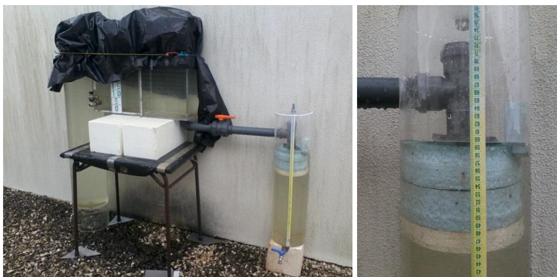
Fig. A.2. Instalação experimental e pormenor do sistema de flutuadores.
