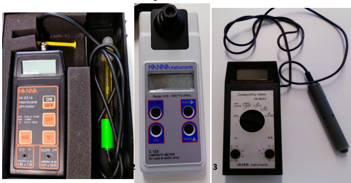
Fig. A.1. (1) Medidor de pH e temperatura “HI8314”; (2) Medidor da turvação “HI93125”; (3) Medidor multi-gama de condutividade elétrica “HI8033”.
