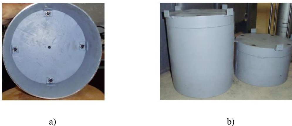
Figura 3.2 – Modelos físicos das saias estruturais e da sapata: a)saia vista do seu interior e b)saia curta e saia longa vista em perfil (Alves, 2014).
