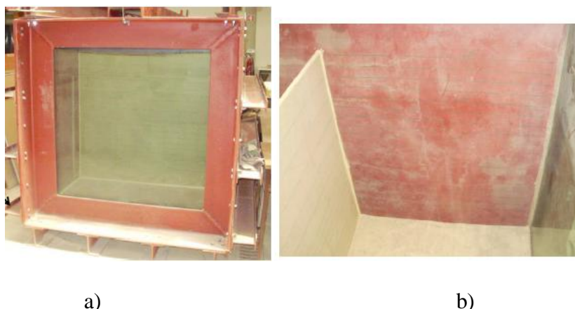
Figura 3.1 – Características do tanque: a)reforçado lateralmente e b)com marcações para controlo da altura (Alves, 2014).
