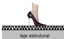
Figura 5.14 – Laje com revestimento flexível
