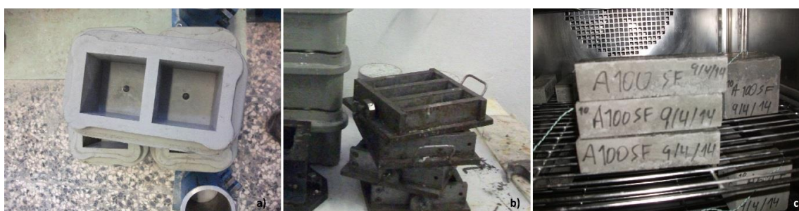
Figura 4.2 - Moldes utilizados: a) Forma Cúbica b) Forma paralelepípedica c) Provetes de argamassa em cura na câmara térmica
