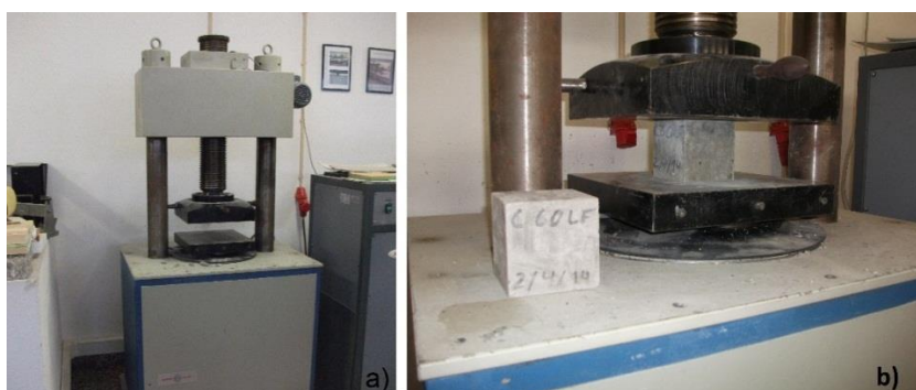
Figura 4.5 - Ensaios de resistência à compressão: a) Prensa Microtest; b) Ensaio.
