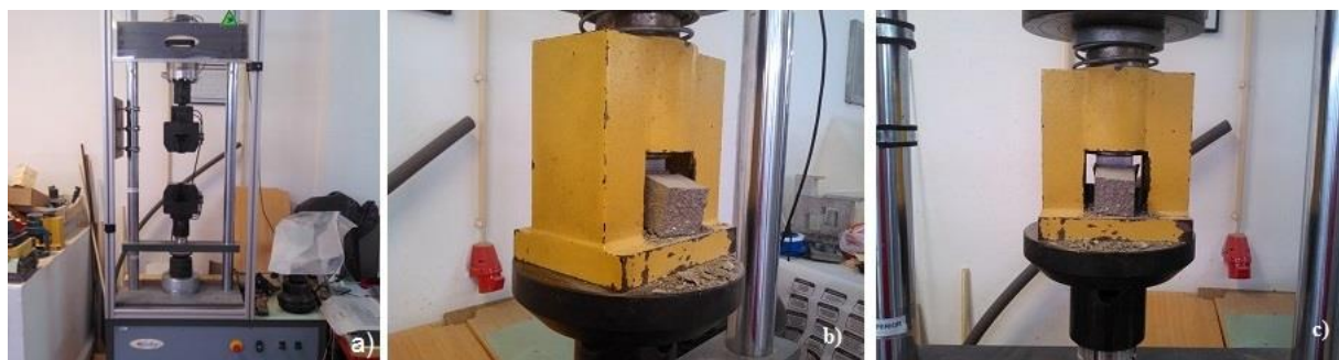
Figura 4.6 – a) Prensa universal e ensaio de resistência à compressão; b) Ensaio de resistência à compressão de provetes de argamassa
