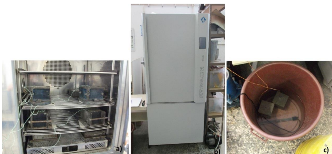
Figura 4.3 - Condições de Cura: a) Interior da câmara térmica; b) Câmara térmica ; c) Cura em recipiente com água
