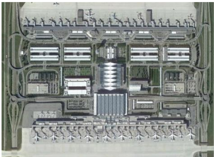
Figura 2.1 - Terminal linear (Aeroporto de Munique)
