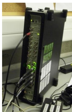
Figura 3.19- Sistema de aquisição multianalisador Pulse
