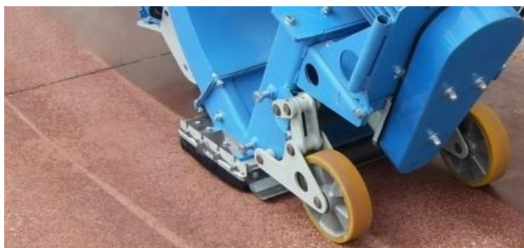
Figura 3.4 – Pavimento antes e após a granalhagem e respetiva máquina granalhadora (Luso Granalhagem, 2014).
