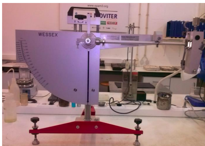
Figura 4.16 – Pêndulo Britânico do Laboratório de Pavimentos Rodoviários.
