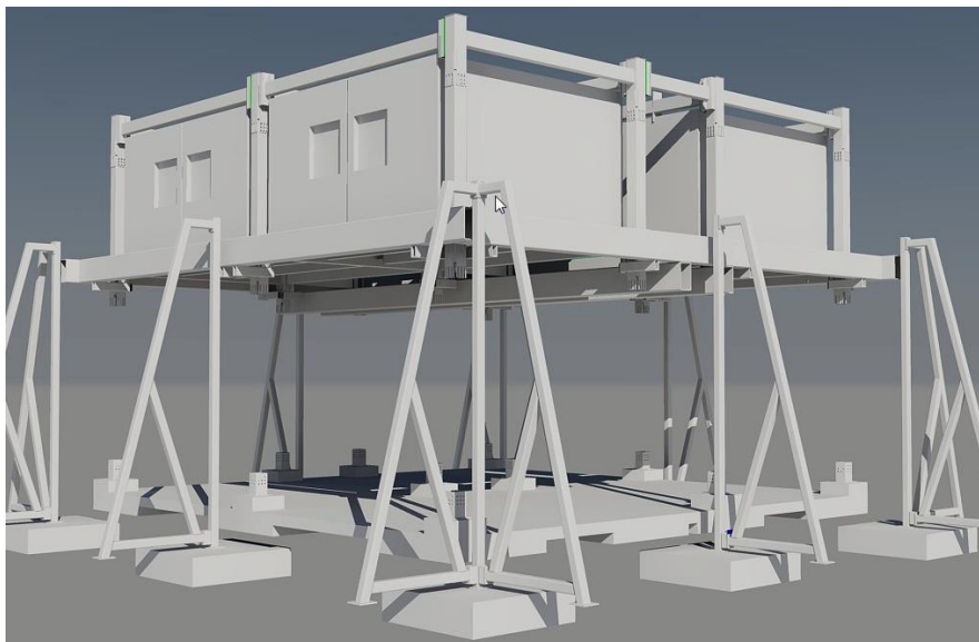
Figura 1.3 - Esboço do processo de levantamento (RFSR, 2011)
