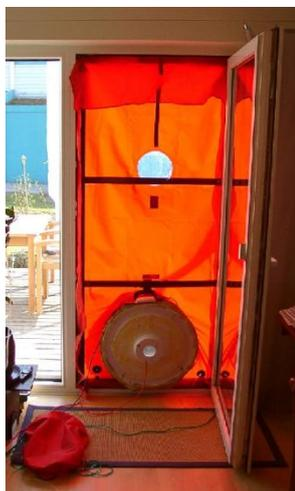
Figura 5.4 – Equipamento do BDT instalado numa porta (PHI, 2014)
