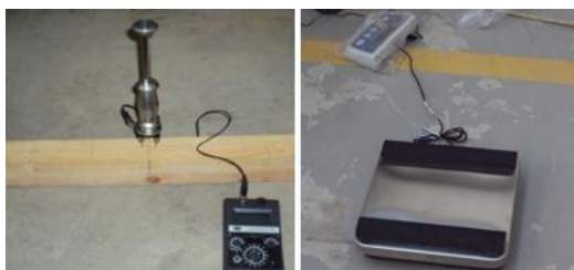
Figura 3.12 - Humidímetro de agulhas (à esquerda) (Bernardo, 2015) e balança (à direita)
