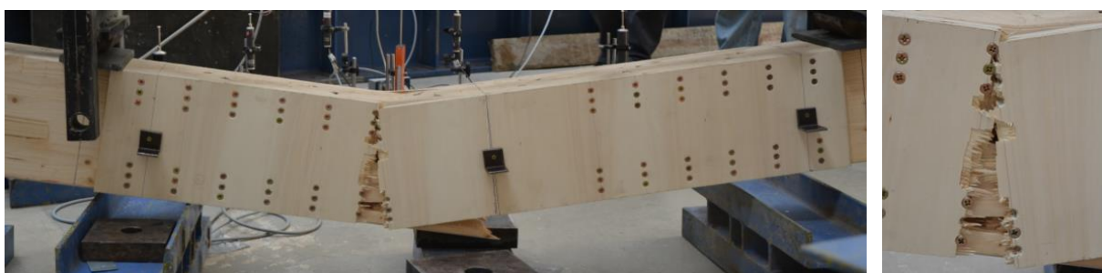
Figura 4.16 - Rutura da Viga 5
