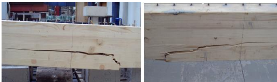
Figura 3.7 - Fissuras da Viga 11
