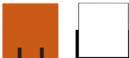
Figura 2.6 - Configuração do reforço com chapas (à esquerda) (Garcia et al, 2013) e tecidos de FRP (à direita) (D'Ambrisi et al, 2014)
