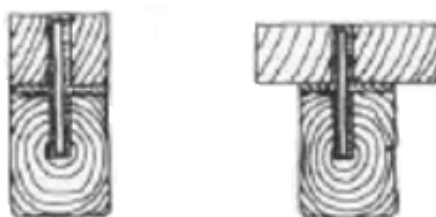
Figura 2.18 – Aplicação do novo elemento com a mesma largura do existente (à esquerda) e com largura superior (à direita), (Arriaga, 2002)
