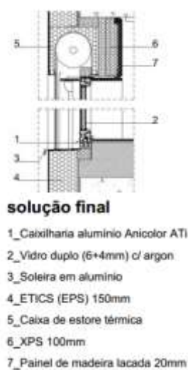
Figura 3.2 – Solução utilizada na primeira habitação Passivhaus em Portugal.
