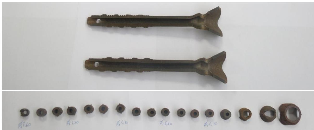
Figura 2.9 - Corte longitudinal e em segmentos na direcção perpendicular de um conector HILTI HCC-B
