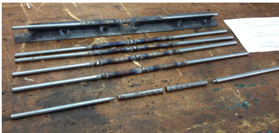
Figura 3.9 - Preparação dos provetes com conectores HCC-B para ensaios de corte-flexão
