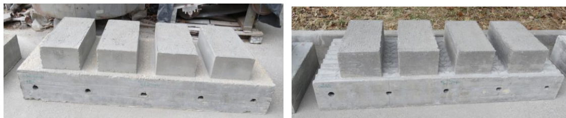
Figura 3.40 - Provetes para execução dos ensaios de corte em laje (laje com tratamento por hidrodecapagem e laje com superfície ondulada)
