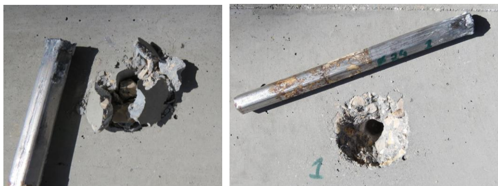
Figura 3.33 - Resultado do ensaio de arrancamento do lado da cabeça do provete Est φ24.1
