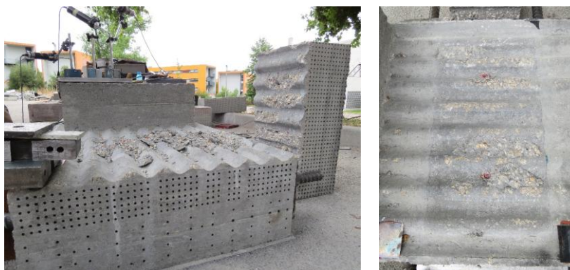
Figura 3.51 - Interface após o ensaio, antes de depois de varrido o material solto
