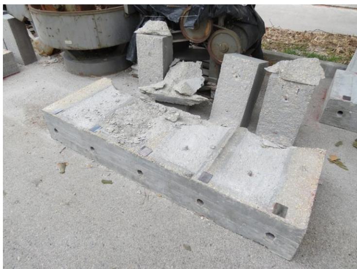
Figura 3.55 - Laje com superfície tratada por hidrodecapagem depois de realizados os ensaios
