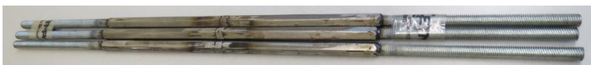
Figura 3.8 - Provetes para ensaio de corte-flexão (provetes TT4.D)
