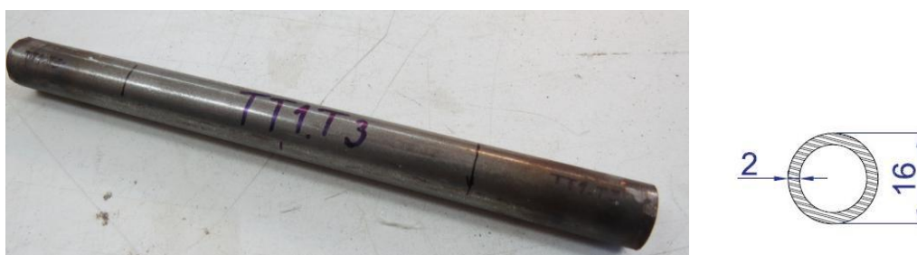
Figura 3.1 - Elemento do tipo TT1 (preparado para ensaio de tracção)
