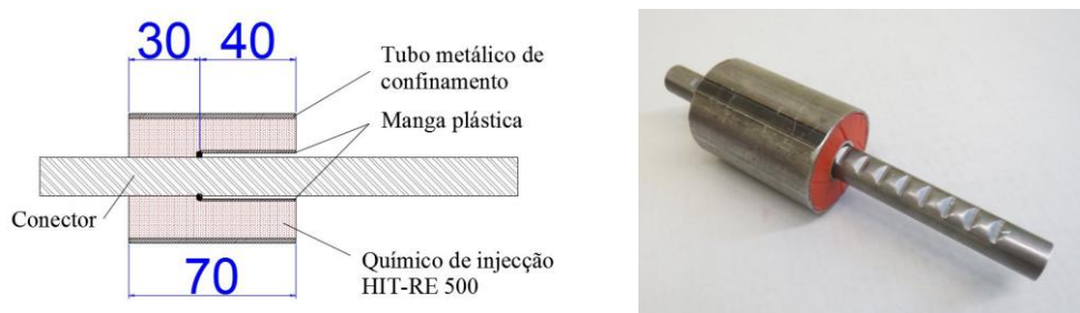
Figura 3.17 - Provetes para os ensaios de arrancamento na cola (esquema e exemplo)
