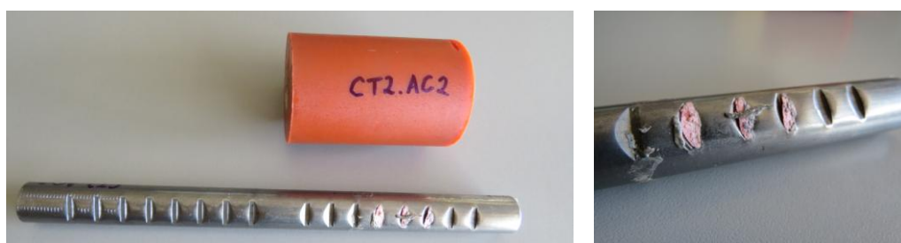
Figura 3.25 - Resultado de ensaio de arrancamento na cola de um provete CT2 e pormenor da cola presa nos entalhes
