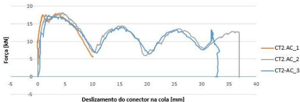
Figura 3.24 - Diagramas Força-Deslizamento dos ensaios de arrancamento na cola dos provetes CT2.AC
