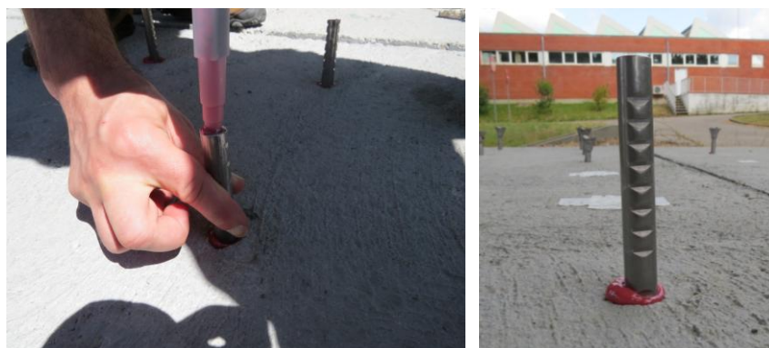
Figura 3.19 - Aplicação dos elementos do tipo CT2 para ensaio de arrancamento em cola e betão
