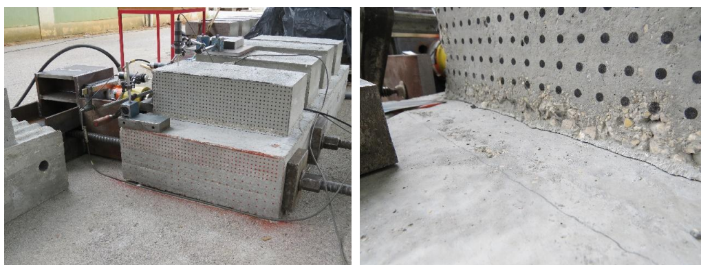
Figura 3.47 - Quebra da adesão entre as duas camadas de betão em ensaio com superfície lisa
