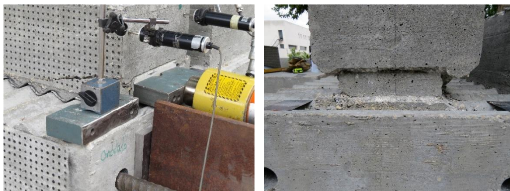
Figura 3.49 - Esmagamento do betão na zona de aplicação da carga nos ensaios com conectores Hilti HCC e superfície ondulada
