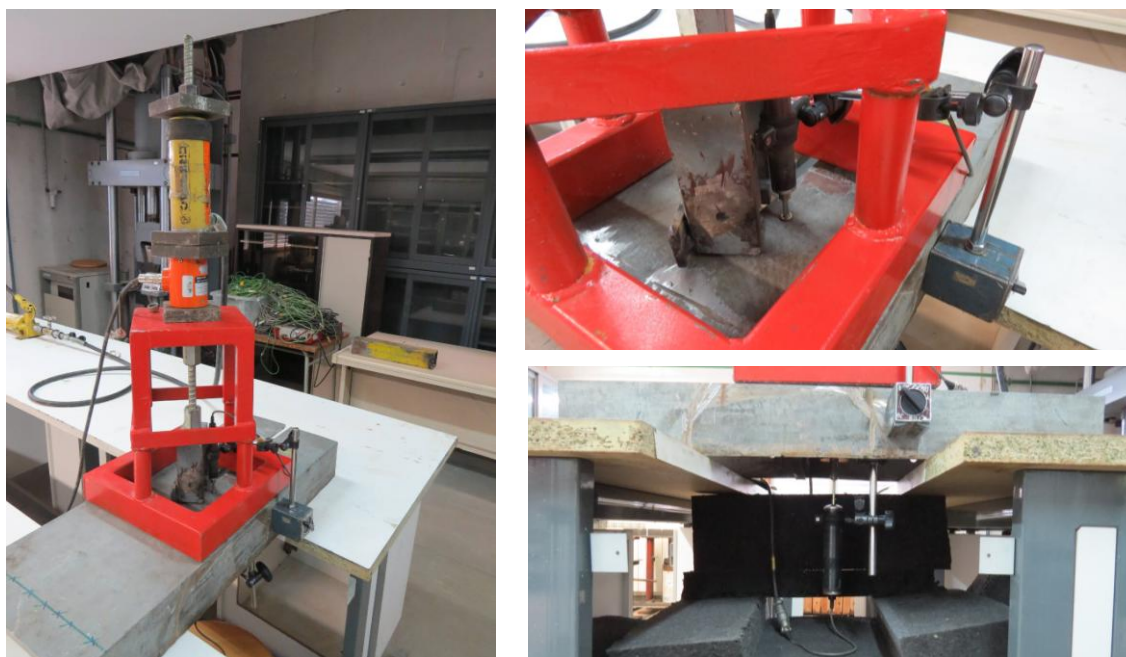
Figura 3.23 - Setup de ensaio de arrancamento na cola e pormenor da colocação dos transdutores de deslocamentos
