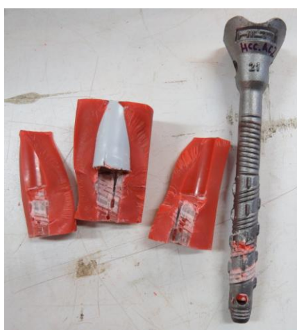
Figura 3.27 - Exemplo de rotura de um provete HCC.AC
