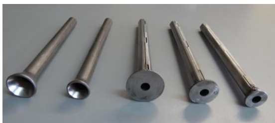
Figura 3.31 - Provetes para a execução dos ensaios de arrancamento do lado da cabeça
