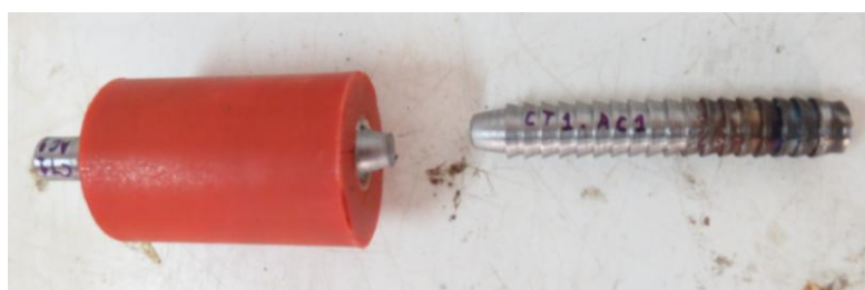
Figura 3.26 - Resultado do ensaio de arrancamento na cola do provete CT1.AC_1
