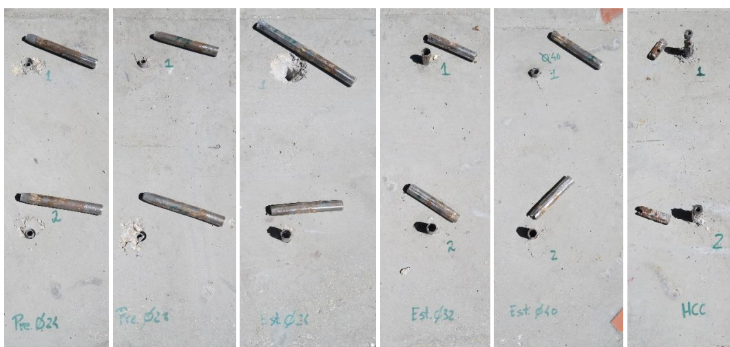
Figura 3.34 - Resultado dos ensaios de arrancamento do lado da cabeça
