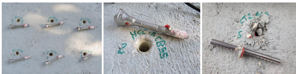
Figura 3.29 - Resultado dos ensaios de arrancamento em cola e betão
