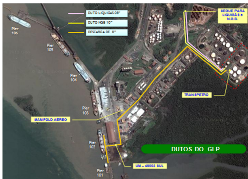
Figura 28. Tubulação de carga e descarga de GLP
