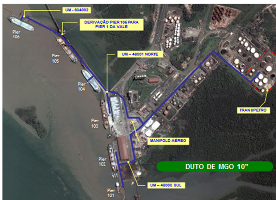
Figura 25. Tubulação de carga e descarga de MGO
