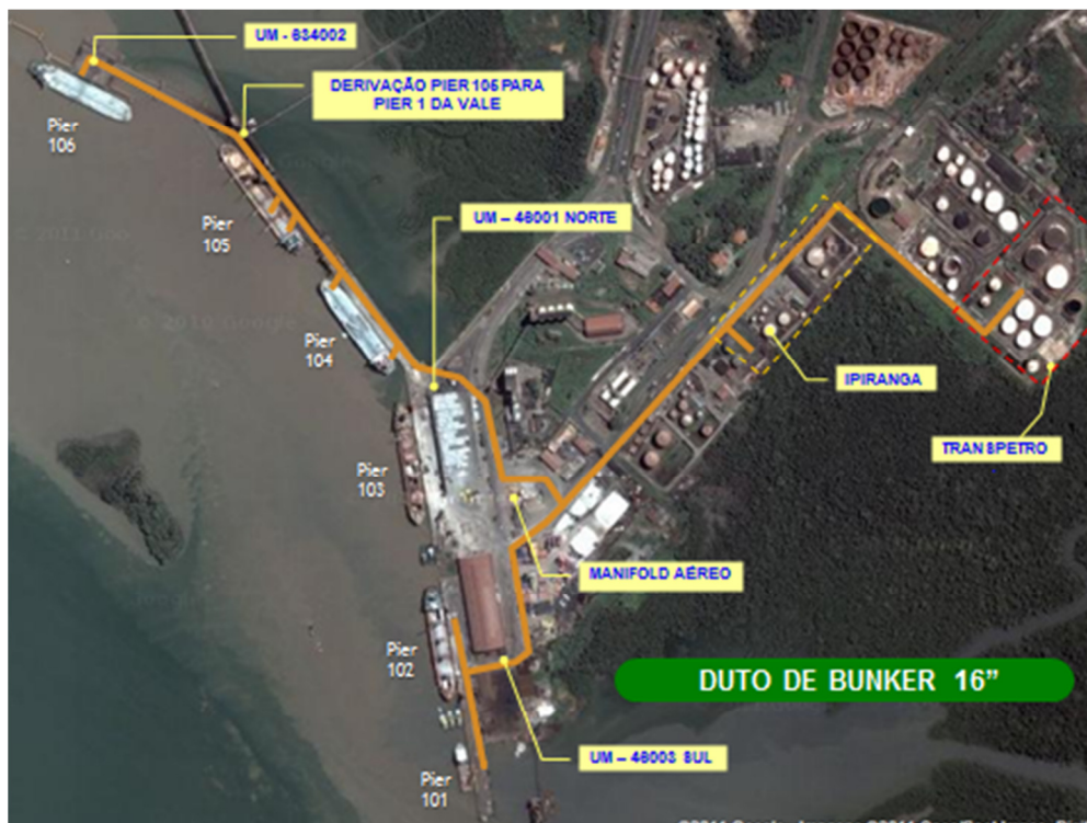
Figura 27. Tubulação de carga e descarga de BPF (Óleo combustível)
