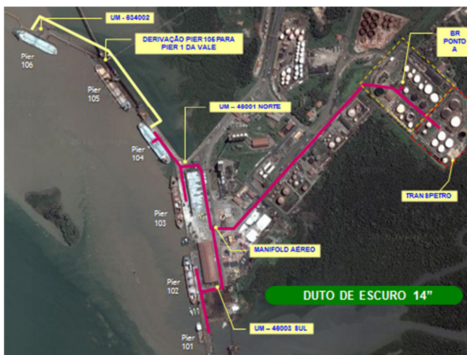
Figura 26. Tubulação de carga e descarga de MF (Marine Fuel)
