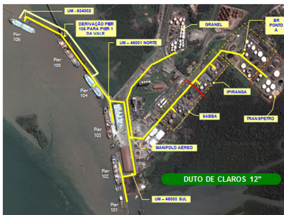
Figura 24. Tubulação de carga e descarga de Óleo Diesel (Fonte: Mapa Google Earth) (Informações de encaminhamento próprio)
