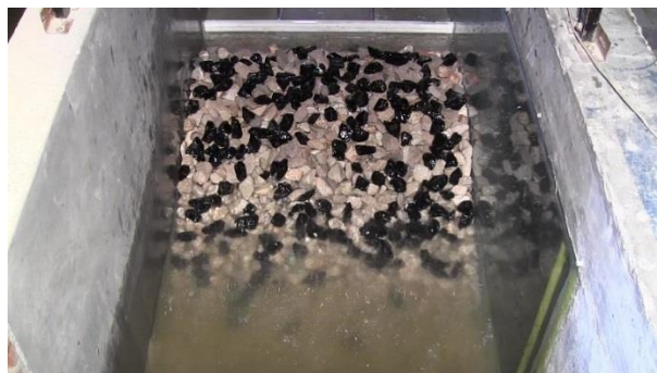
Figura 3.11 – Imagem do ensaio de enrocamento.
