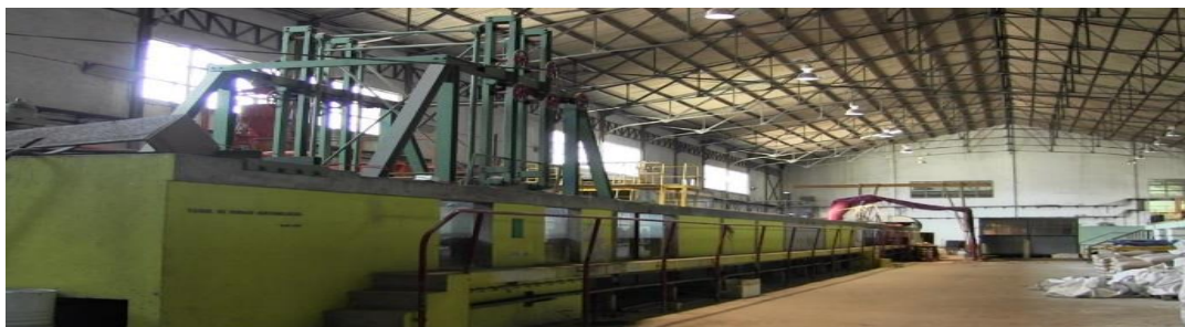
Figura 3.1 - Canal de ondas irregulares COI1.
