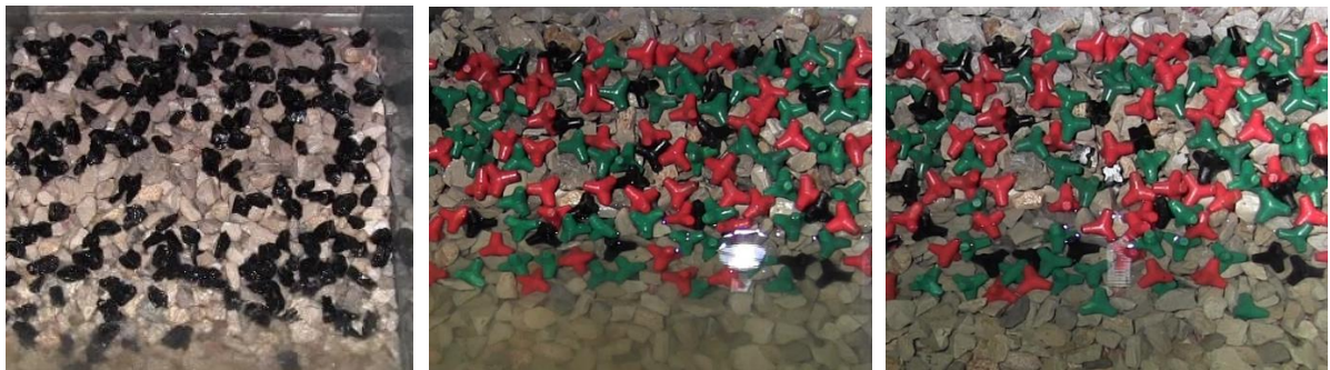
Figura 3.4 – Material constituinte do manto protetor: a) enrocamento; b) tetrápodes; c) tetrápodes e cubos.
