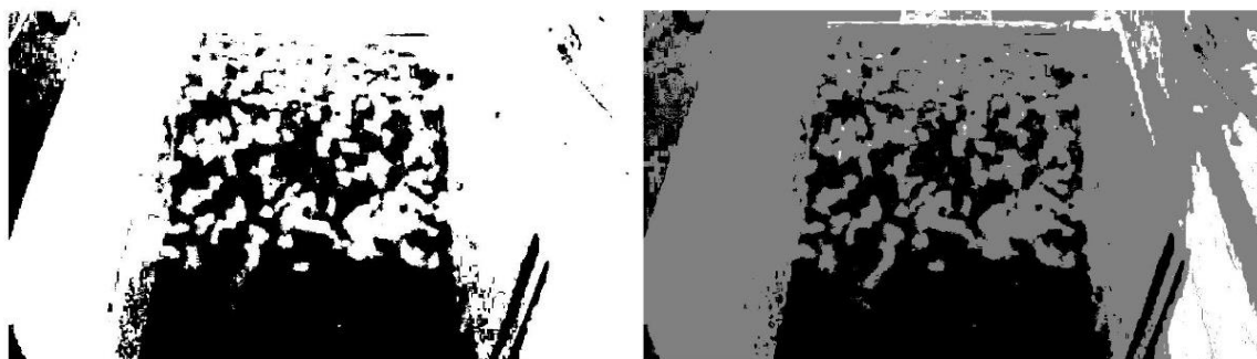
Figura 3.20 – Manchas no talude, enrocamento: a) k=2 ; b) k=3 .
