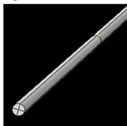
Figura 26. Elemento 3D para os varões de aço
