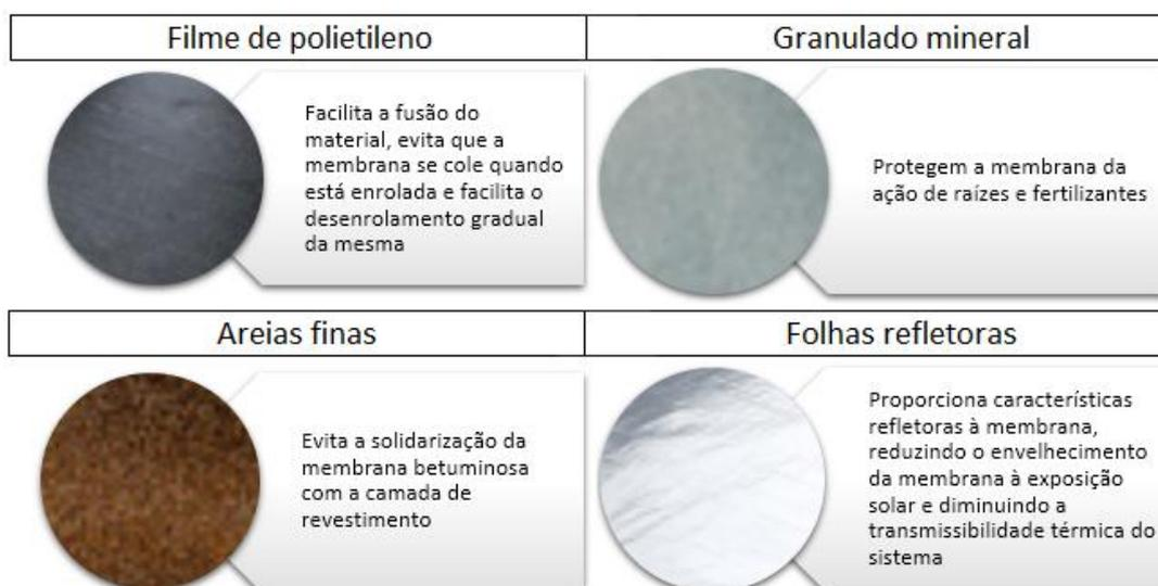
Figura 2.3 - Revestimentos superficiais das membranas de betume polímero (Mascarenhas, 2005)
