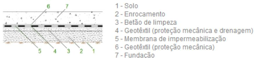
Figura 3.10 – Sistema de impermeabilização de um ensoleiramento geral (Mendes, 2011)
