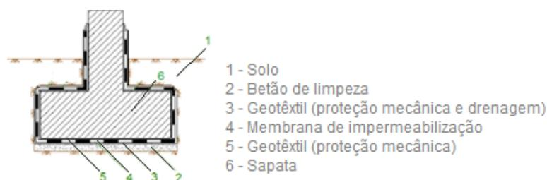
Figura 3.8 – Sistema de impermeabilização de uma sapata isolada (Mendes, 2011)
