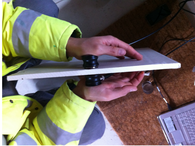
Figura 4.2. – Fotografia dos transdutores aquando da medição de um provete de gesso cartonado.
