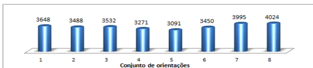
Gráfico 5.1 Ganhos solares acumulados para cada conjunto de orientações fixas dos vãos envidraçados (kW) da casa prevista para Coimbra na estação de arrefecimento
