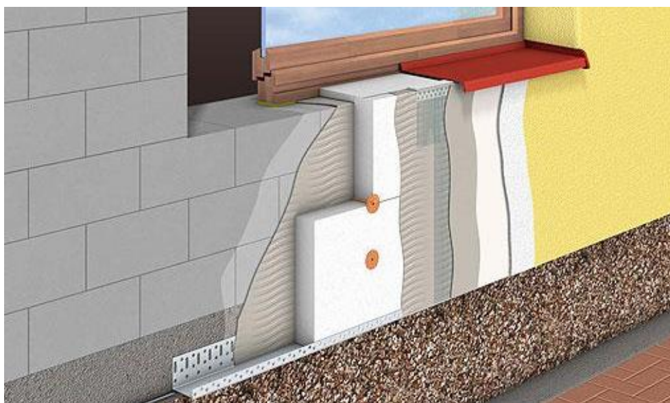
Figura 2.2 - Revestimento delgado armado sobre isolamento térmico
