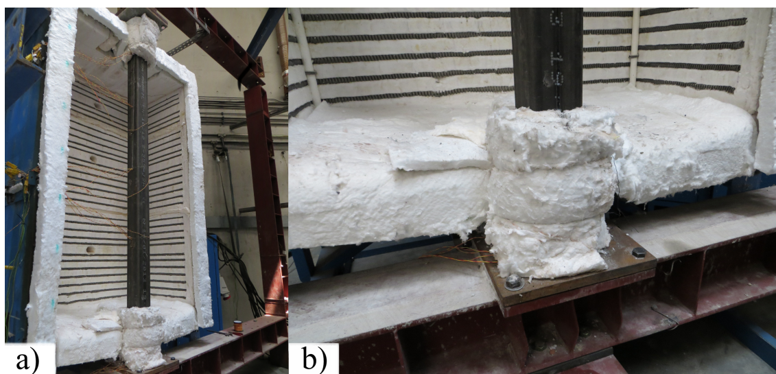
Figura 3.13 – Exemplo do isolamento com fibra cerâmica a) Vista geral do elemento b) Pormenor da base da coluna
