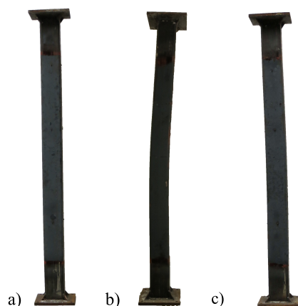
Figura 3.23 – Deformada após ensaio para colunas com 220mm de lado a)S2R13 b)S4R128 c)S6R45
