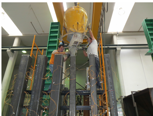
Figura 3.10 – Betonagem dos modelos experimentais
