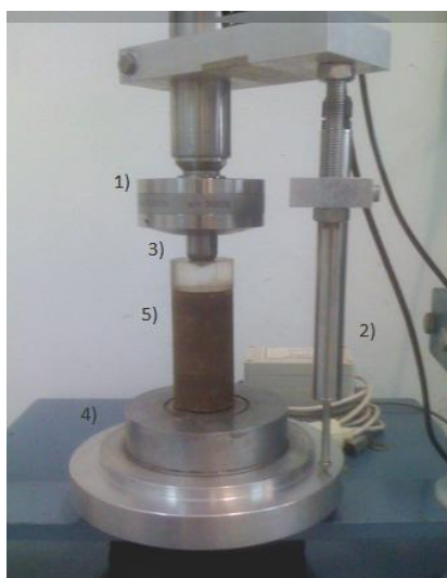
Figura 5.1 - Aspecto completo de um ensaio de compressão não confinada (UCS).
