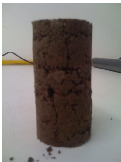
Figura 5.24 - Provetes laboratoriais preparados com as novas Técnicas: Técnica 2 (tapping).
