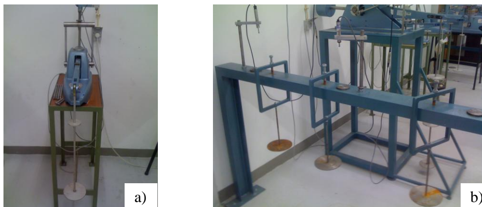
Figura 4.5 - Edómetros utilizados: a) edómetro com braço de carga; b) edómetro de carga direta.
